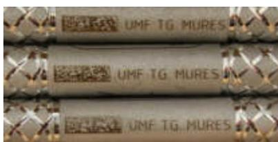
Bild 12) UIM auf Instrument mit rechteckigem DataMatrix (DMRE)
