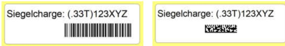
Bild 2) Siegelchargen-Etikett intern ( links mit Code 128, rechts mit DataMatrix (8x32)
