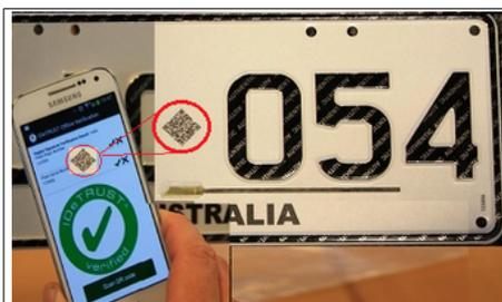
Bild 16) DigSig in QR+RFID für Check von Autoschildern per Smartphone
