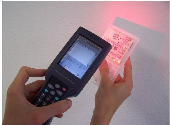
Bild 1) Scannen eines HIBC mit einem Mobilgerät
